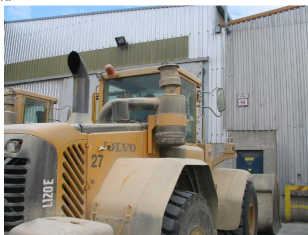
Pravilna postavitev filtra – TAKO NAJ BO POSTAVLJEN
